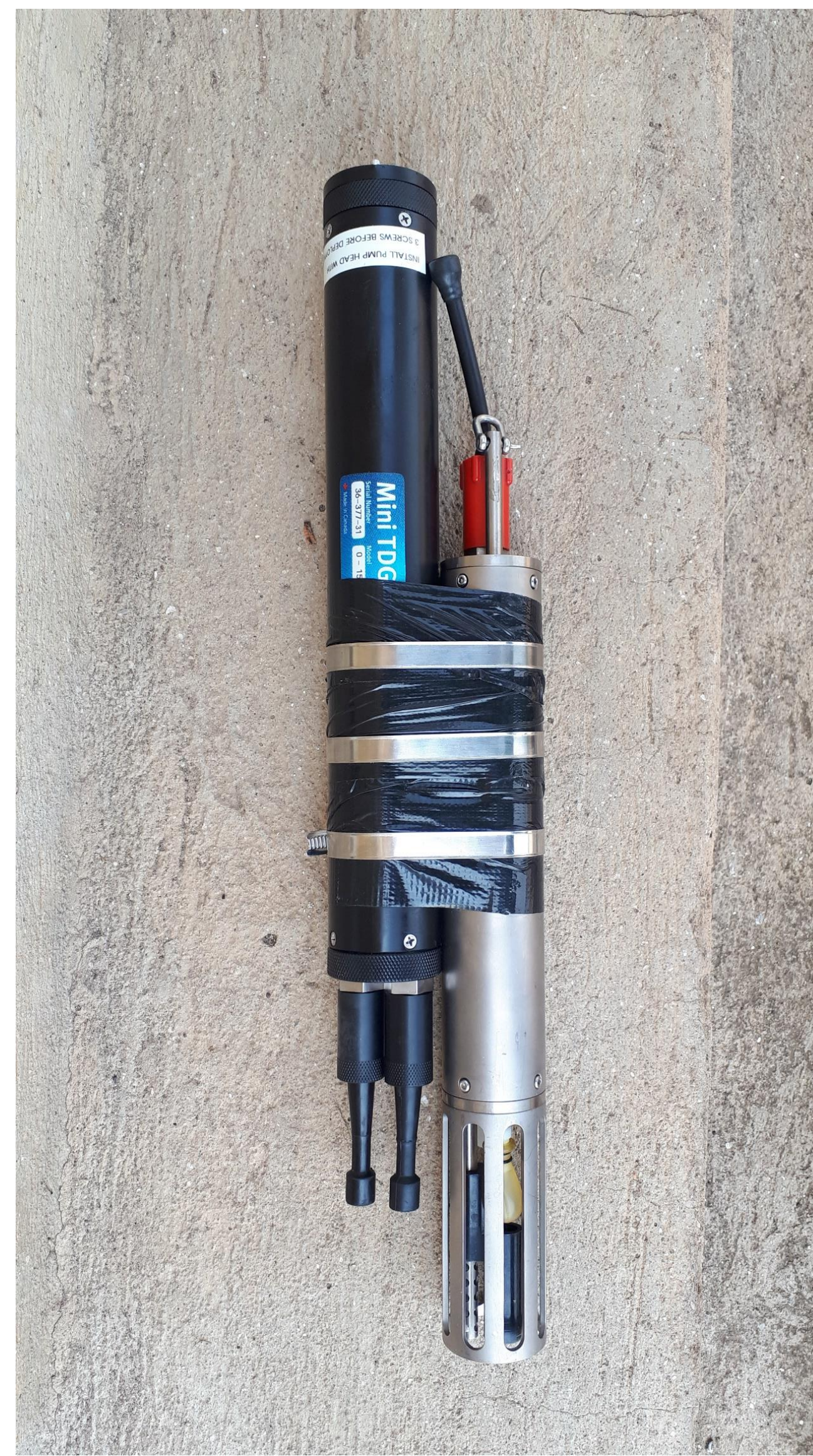
Modified Pro Oceanus Mini TDGP Probe with Sea & Sun CTD Probe
