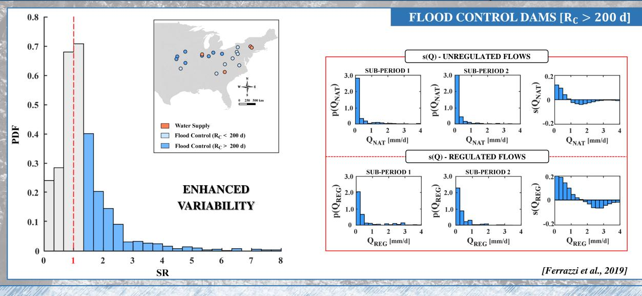
HIGH REGULATION CAPACITY DAMS ENHANCE FLUCTUATIONS BY UNEVEN OPERATIONS
